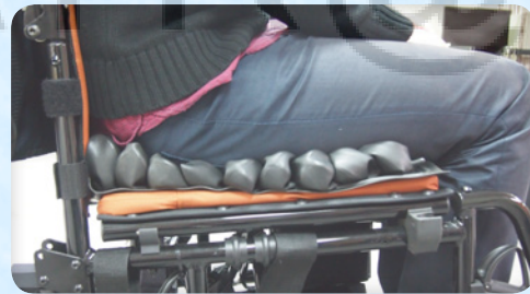
▲ 座墊充氣不足，無法有效支撐使用者臀部，且易產生觸底的情況。
